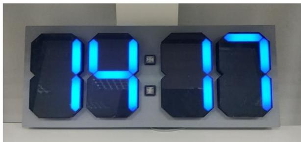
времени и управляющий контроллер Arduino Nano. Контроллер считывает данные с датчика и модуля часов и выводит эти значения на экран, который спаян из светодиодной ленты. Зажигая ту или иную комбинацию светодиодов, можно получить необходимое изображение. Часы [рисунок 6]
